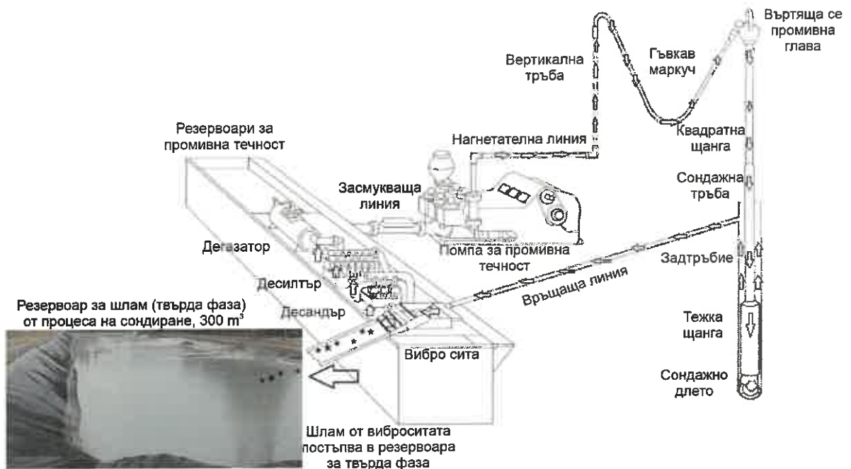
Фиг. 20 Схематично представяне на система за почистване на рециркулираща промивна течност
