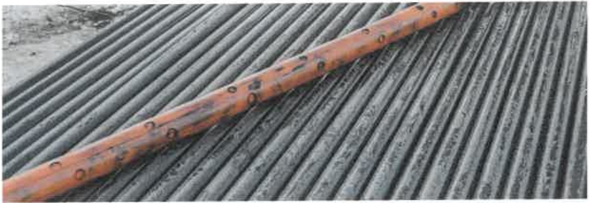
Фиг. 9. Перфорационна тръба с разположение на зарядите
